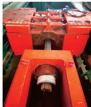
55孔高强度钢绞线拉索组件疲劳验证试验
