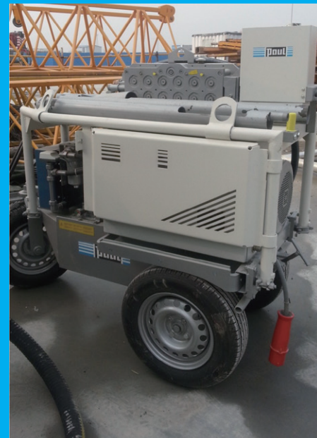
● 液压穿索机 液压、平稳、顺畅、强劲 移动方便、操作简单、可遥控 最大推力:5KN 尺寸:2070X820X1500mm 重量:750kg
